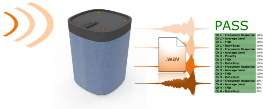
图 11: 使用 Klippel QC 基于音频文件测试一款智能音箱的四个麦克风响应
