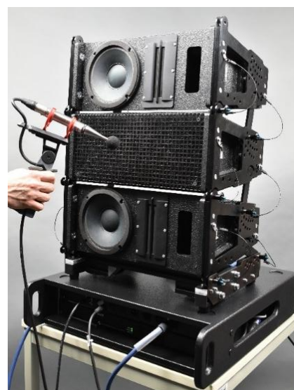
图3: 使用流式传输 V/I 放大器和 QC 脱机版软件对租赁扩声设备进行快速、高效且经济的质检
