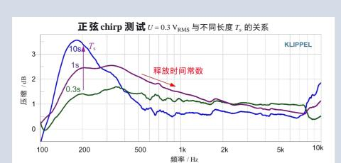
解读: Chirp 激励产生的压缩 C(f,t) 揭示了瞬态滤波器响应 H(f,t)。低扫描速度的长chirp 信号 $(T_s=10 \text{ s})$ 提供与步进正弦测试类似的结果。短时向上扫描测试 $(T_s<2 \text{ s})$ 在较高频 率处显示出额外的由物理模型中积分器的释放时间 $T_{REL}$ 引起的压缩。
