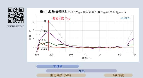
解读: 步进单音测试显示了蓝牙音箱产生幅度压缩的关键激励条件: 音圈位移在低频段激活主要的换能器非线性。保护系统通过使用大约0.3 s的启动时 间来预测音圈位移,以防止机械过载和过度失真。对于较短的激励长度  $T_{ON}$  和较长 的中断时间 $T_{OFF}$ ,发热可以忽略不计。
