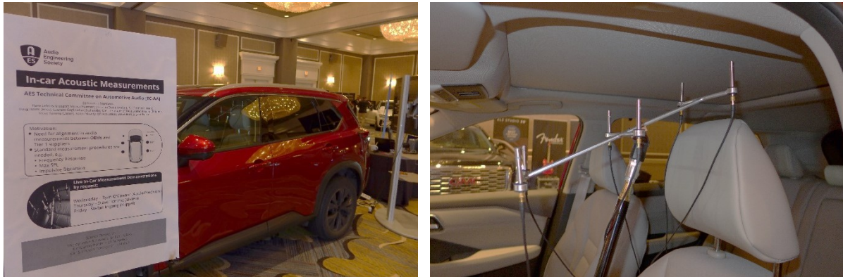
图 4+5：2022 年 7 月在底特律举行的 AES 汽车音频会议上展示使用麦克风阵列的汽车声学测试设置
