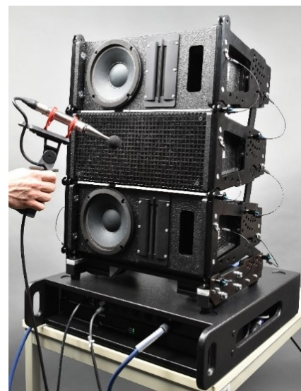
图3: 使用流式传输 V/I 放大器和 QC 脱机版软件对租赁扩声设备进行快速、高效且经济的质检
