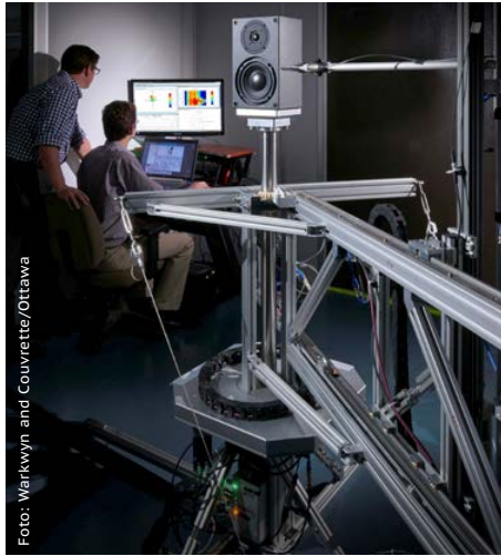
Abb. 2: Holographische Messung des vom Lautsprecher erzeugten Schallfeldes mit Hilfe eines Nahfeldscanners
