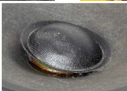
Leaky dust cap
